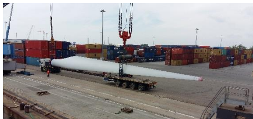
Une des trois pales de l'éolienne : 40 mètres
