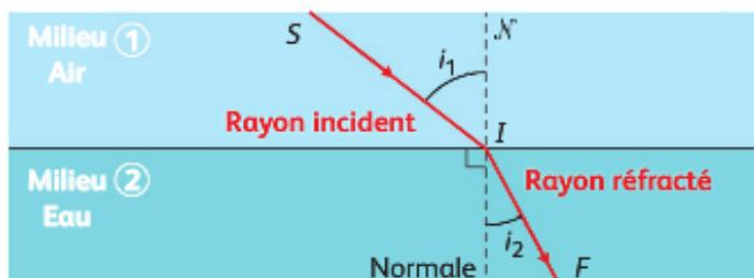
On appelle **normale** (notée  $\mathcal{N}$  sur le dessin ci-dessus) la droite perpendiculaire en un point  $I$  à la surface de séparation des deux milieux,  $i_1$  l'angle d'incidence entre le rayon incident et la normale,  $i_2$  l'angle de réfraction entre le rayon réfracté et la normale.
