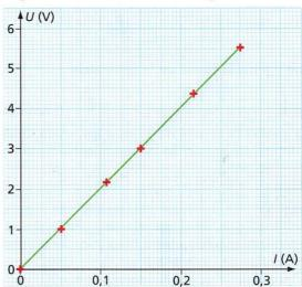
Chloé a tracé la caractéristique d'un dipôle ohmique.
