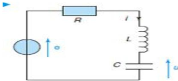
A l'instant  $t=0$  la tension  $e$  passe de la valeur nulle à la valeur  $E$ . le circuit RLC est soumis à un échelon de tension, quand le circuit est fermé
