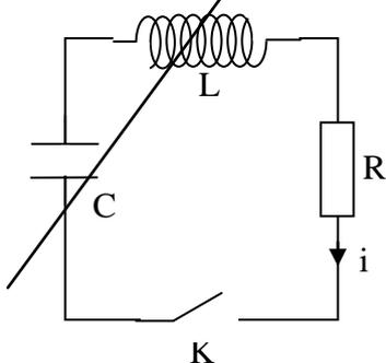
a)- Dans le circuit ci-contre, le condensateur est initialement chargé sous la tension  $u_m$ , l'interrupteur K étant ouvert.
