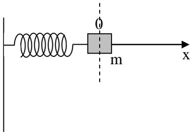
La masse est maintenue en  $x = 0$  par un ressort de masse négligeable et de raideur  $k$ . On l'écarte de sa position d'équilibre et on la lâche. Le système oscille avec une période:
