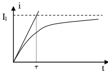
b)-La courbe d'établissement du courant  $i$  dans le circuit en fonction du temps a l'allure ci contre. La valeur limite de l'intensité s'écrit:
