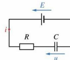
Si le condensateur est totalement déchargé à l'instant initial  $t = 0$ , la tension aux bornes du condensateur est donnée en fonction du temps  $t$  exprimé en s (seconde) par l'expression :
