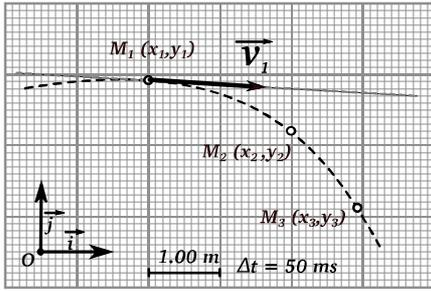
Figure 4.6 – Le vecteur vitesse au point  $M_1$  se calcule à partir de la vitesse moyenne entre les points  $M_1$  et  $M_2$  et se dessine au point  $M_1$  tangent à la trajectoire, dans le sens du mouvement
