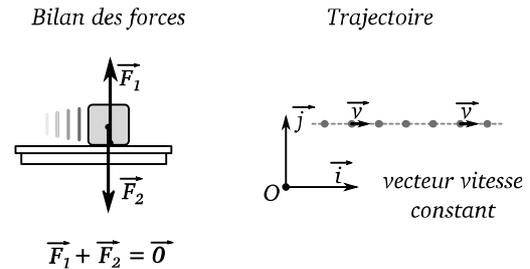
Figure 4.16 – Un objet sur lequel les forces se compensent peut avoir un mouvement rectiligne et uniforme. Un objet en mouvement rectiligne et uniforme est soumis à des forces qui doivent se compenser.
