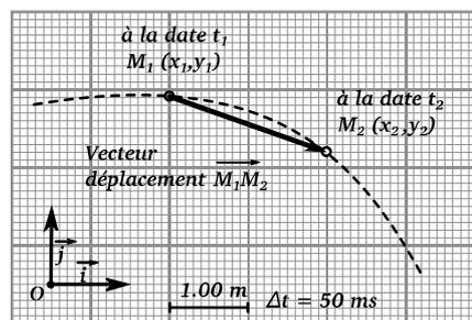
Figure 4.3 – Le vecteur déplacement permet de passer du point  $M_1$  de la trajectoire au point  $M_2$
