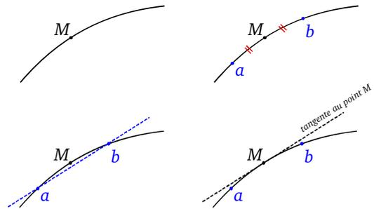
Figure 4.5 – Tracer une tangente au point  $M$
