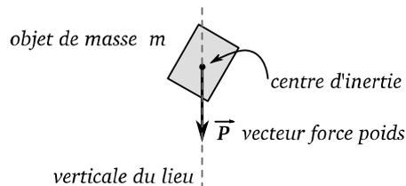
Figure 4.13 – Le poids d'un objet de masse  $m$  est une force d'interaction à distance que l'objet subit à proximité de la surface d'une planète.
