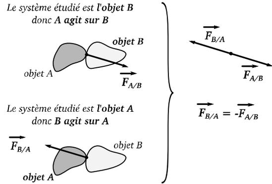
Figure 4.10 – Si le système étudié est l'objet  $B$  alors l'objet  $A$  exerce une force sur l'objet  $B$   $\vec{F}_{A/B}$ . Si le système étudié est l'objet  $A$  alors l'objet  $B$  exerce une force sur l'objet  $A$   $\vec{F}_{B/A}$ . D'après le principe des actions réciproques  $\vec{F}_{B/A} = -\vec{F}_{A/B}$
