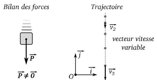
Figure 4.17 – Un objet en chute libre sans frottement a un mouvement rectiligne accéléré. Les forces ne se compensent pas, le vecteur vitesse change.
