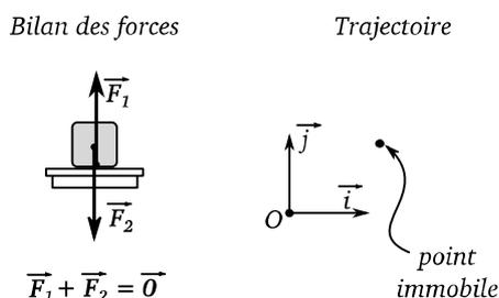
Figure 4.15 – Un objet sur lequel les forces se compensent peut rester immobile. Un objet immobile est soumis à des forces qui doivent se compenser.
