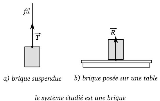
Figure 4.11 – Les interactions de contact nécessitent que les objets interagissants se touchent.
