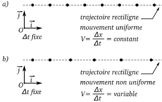
Figure 4.7 – La figure a) représente un mouvement rectiligne et uniforme, l'objet se déplace en ligne droite à vitesse constante. La figure b) représente un mouvement rectiligne non uniforme, l'objet se déplace en ligne droite mais sa vitesse varie, ici, elle augmente, l'objet accélère.
