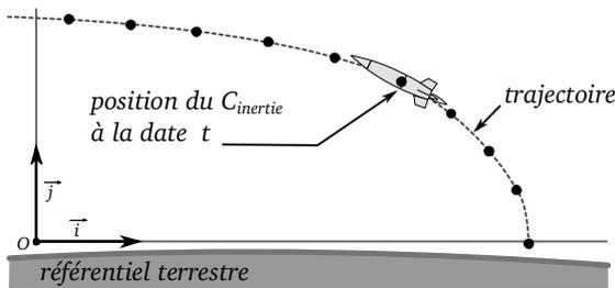
Figure 4.2 – La trajectoire d'un point matériel est la courbe définie par les positions successives du centre d'inertie de l'objet au cours de son mouvement décrit dans un référentiel
