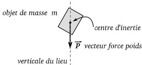
Figure 4.14 – Le poids d'un objet de masse  $m$  est une force d'interaction à distance que l'objet subit à proximité de la surface d'une planète.
