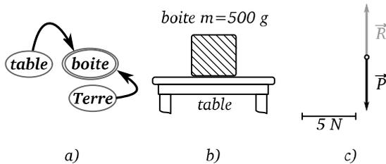
Figure 4.9 – Le système étudié est une boîte posée sur une table et sous l'influence de la Terre (figures a et b). On modélise la boîte par un objet ponctuel soumis aux forces  $\vec{P}$  et  $\vec{R}$  (figure c).
