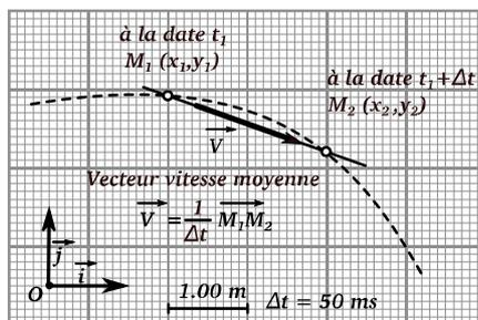
Figure 4.4 – Le vecteur vitesse moyenne se calcule à partir du vecteur déplacement entre deux points de la trajectoire séparés par une durée  $\Delta t$
