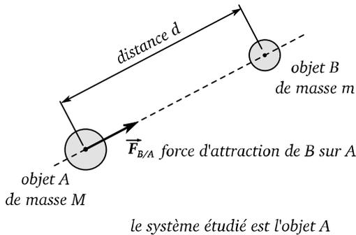
Figure 4.12 – Le système étudié est un objet A de masse  $M$  qui subit de la part d'un objet B de masse  $m$  une force d'attraction gravitationnelle  $\vec{F}_{B/A}$
