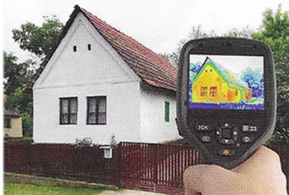
**b** Une caméra infrarouge visualise le rayonnement IR-C d'un bâtiment afin d'en évaluer les pertes thermiques (les zones qui rayonnent le plus sont repérées en rouge).
