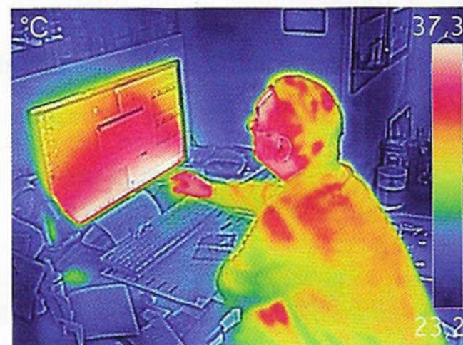
**c** Une mesure de température par thermographie. Les objets de la pièce (en bleu) sont à température ambiante, contrairement à l'écran d'ordinateur et à l'utilisateur.
