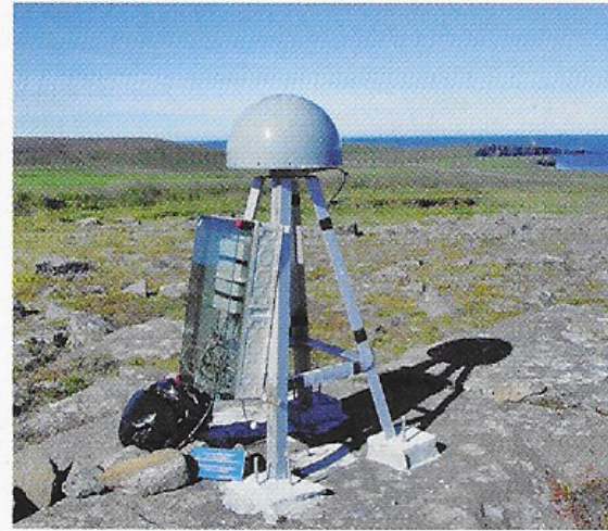
B Un récepteur GPS fixe, de haute précision.
