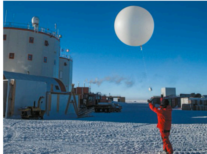
Radiosondage équipé de capteurs de pression, de température et d'humidité.
