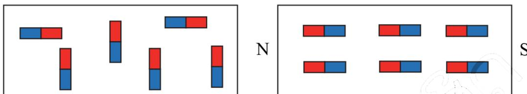
FIGURE 14.2 – Morceau de fer (ou nickel) avant et après placé dans un champ magnétique
