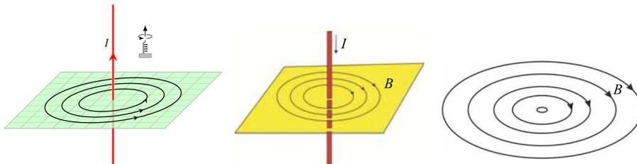
FIGURE 12.5 – Direction du courant et champ magnétique créé par un fil infini
