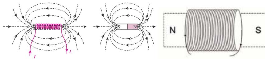
FIGURE 12.2 – Les lignes de champ magnétique créé par une bobine parcouru par un courant  $I$  sont semblables à celles qui apparaissent autour d'un aimant en forme de barreau. Les faces de la bobine se comportent comme les pôles de l'aimant
