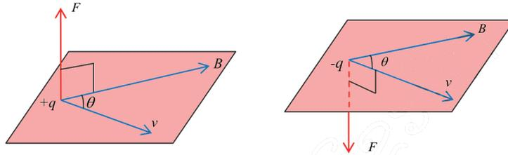
FIGURE 12.3 – Direction de force magnétique
