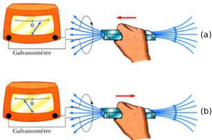
FIGURE 15.2 – Variation du courant lorsqu'on varie le sens du champ magnétique
