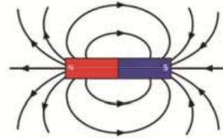
FIGURE 12.4 – Les lignes de champ sont orientées du Nord vers le Sud à l'extérieur de l'aimant.
