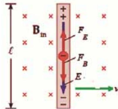
FIGURE 15.4 – Force électromotrice dans un conducteur
