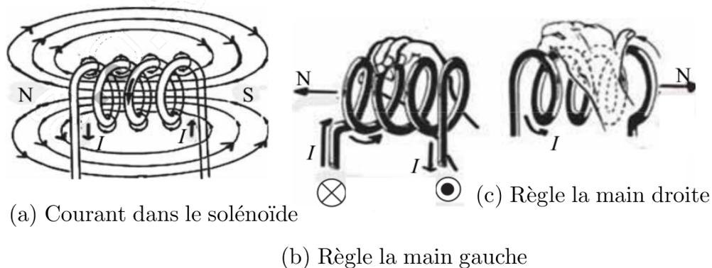
FIGURE 13.3 – Sens du courant et sens du champ magnétique dans le solénoïde.  $\odot$  Le sens du courant est dirigé vers l'avant du plan;  $\otimes$  Le sens du courant est dirigé vers l'arrière du plan.
