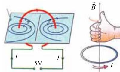
FIGURE 13.2 – Sens du champ magnétique créé par un conducteur circulaire parcouru par le courant
