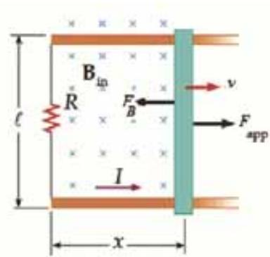
FIGURE 15.5 – Tige conductrice se déplace sur un rail, crée un potentiel électrique
