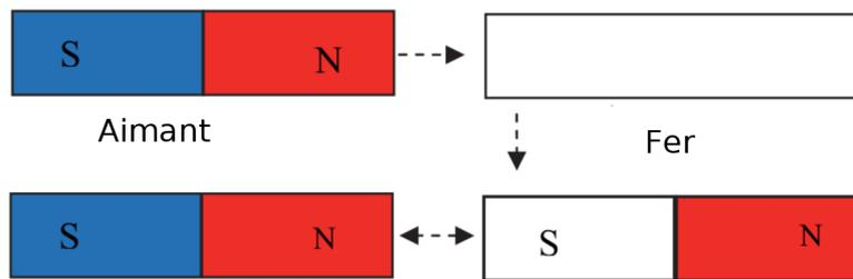
FIGURE 14.1 – Aimant induite du fer (ou nickel)
