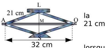
En utilisant les notations du schéma ci-dessus : La longueur cherchée est celle de la diagonale verticale LS.
