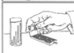
2. Appliquer les 2 faces de la lame sur la surface à contrôler
