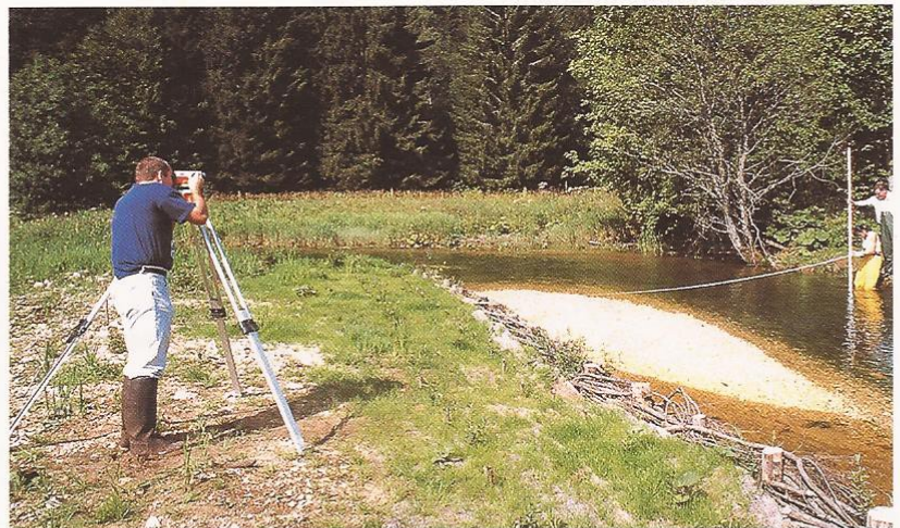
Un méandre reconstitué dans l'ancien lit de la rivière, un an après sa remise en eau. Des techniciens mesurent l'évolution du méandre.
