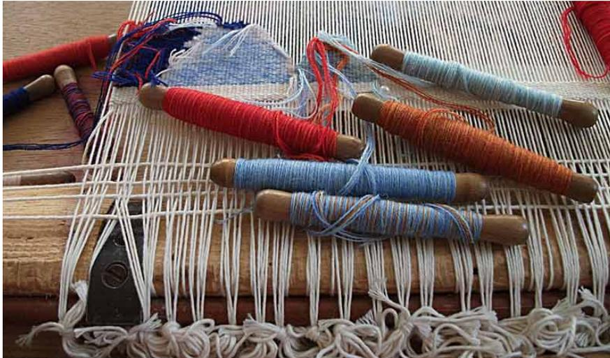
En suivant le carton le lissier est amené à faire des fondus enchaînés, passages de couleurs (appelés par les initiés « battages »). Dans l'opération finale, muni d'un fil et d'une aiguille, il va s'atteler à la **couture**, créant, en l'absence éventuelle de « croisages », des « relais » aux endroits où la tapisserie suivant le dessin plus ou moins complexe, est susceptibles de comporter de légères ouvertures.
