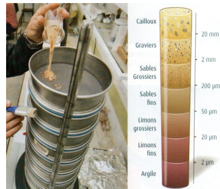
Colonne de tamis pour déterminer la granulométrie d'un échantillon (Belin Ed.2019, pp 114)
