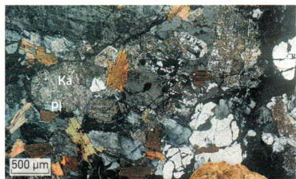
A Observation d'un granite altéré au microscope en lumière polarisée analysée.
