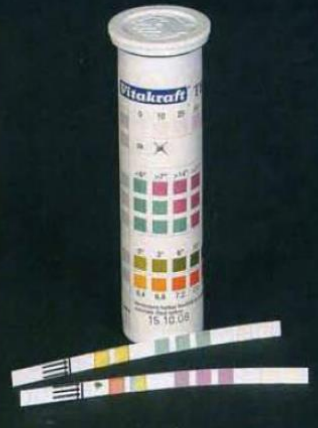
pour contrôler le pH on utilise un indicateur coloré
