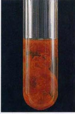
Doc. 3 L'ajout de quelques gouttes de soude dans une solution contenant des ions fer (III) provoque l'apparition immédiate d'un précipité ; les réactions de précipitation sont généralement instantanées.
