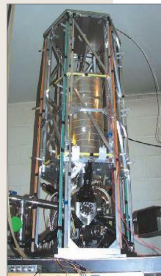
4 Fontaine à atomes refroidis par laser.
