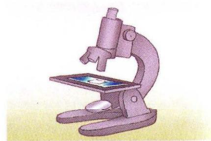
**f** Installe la lame sur le microscope et observe au moyen grossissement. Enfin, règle la netteté avec la grosse vis.
