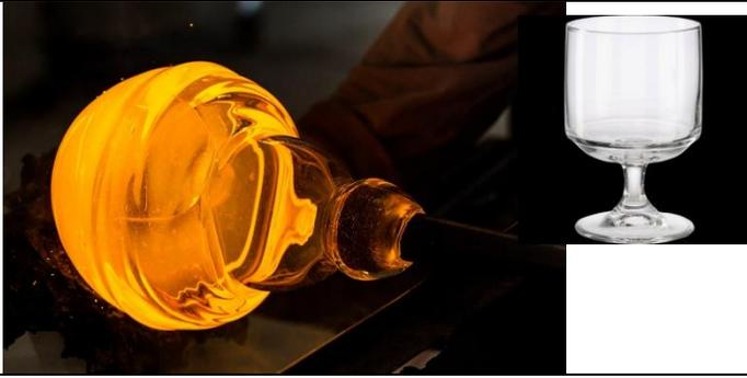
Pour fabriquer du **verre**, il faut mélanger du sable avec deux produits chimiques : de la soude et de la chaux que l'on chauffe à 1 600 °C. Le mélange devient alors du **verre** liquide qui **est** versé dans un moule. En refroidissant, il prend sa forme définitive, transparente et solide.
