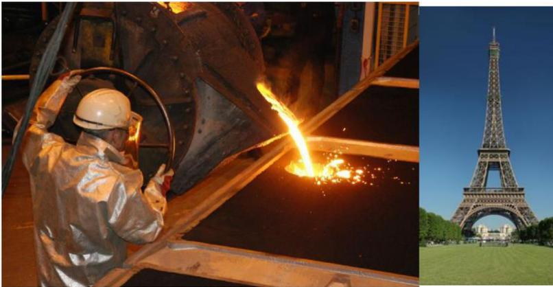
↳ **L'acier** qui compose la Tour Eiffel est un mélange de fer et de carbone. A 1400°C, le mélange est en fusion et peut être coulé dans des moules adaptés.
