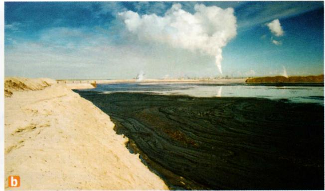
Depuis 1967, les **sables bitumineux** de l'Alberta (Canada) sont exploités dans de grandes mines à ciel ouvert (a). Ces sables contiennent environ 11 % d'un bitume beaucoup plus visqueux que le pétrole conventionnel. D'abord extrait dans d'immenses bacs de décantation, le bitume est aujourd'hui pompé comme le pétrole brut après injection profonde de vapeur d'eau, puis traité sur place. Ces mines ont apporté
