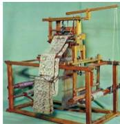
**Automatisme à commande mécanique** : le métier à tisser Jacquard commandé par des cartes perforées (ancêtre de l'ordinateur).
