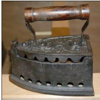
Ce fer à repasser a été réalisé en fonte par **Moulage** ce qui permet une production plus importante. Des braises sont introduites dans le fer pour le maintenir à température.
