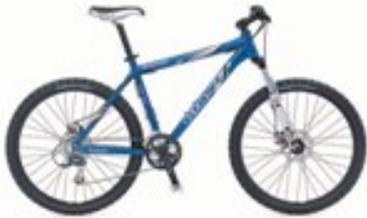
Les pédales, les plateaux, la chaîne et les pignons assurent les fonctions..... et .....de l'énergie motrice fournie par le cycliste à la roue arrière.
