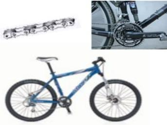
Les pédales, le plateau, la chaîne et les pignons assurent les fonctions **transmission** et **adaptation** de l'énergie motrice fournie par le cycliste à la roue arrière.
